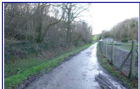
Lors de fortes pluies, le bassin de la station d'épuration déborde. Les apports de ruissellements concentrés sur le chemin d'accès à la STEP contribuent à ce dysfonctionnement. On notera la présence de petits merlons de protection.
